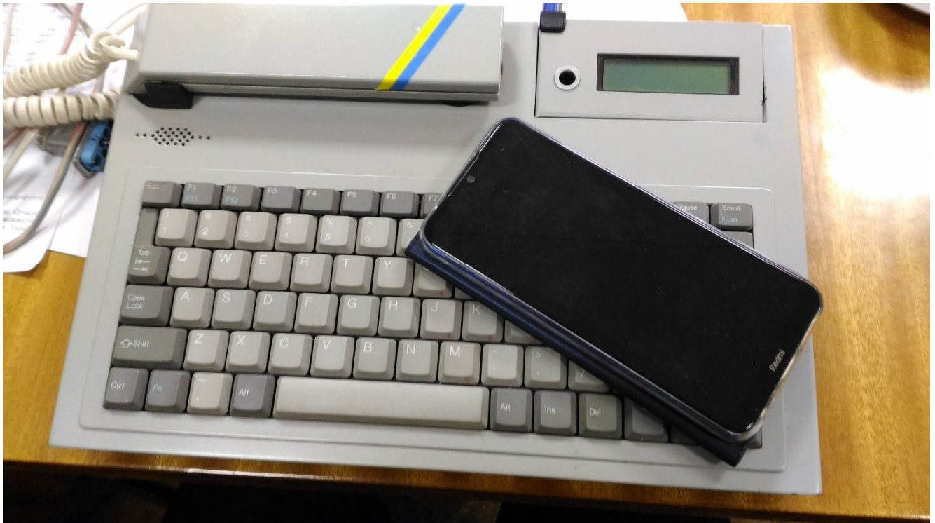
Рис. 1. Робочий макет пристрою для мобільного зв'язку поруч із сучасним смартфоном (розробка 1980-х рр., Інститут кібернетики).
